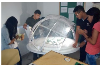
Imagen 5. Análisis solar con heliodón en la asignatura proyecto III de la Universidad de la Costa (fuente: El autor, 2018).
